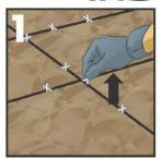
BoquiCREST Ultramax deberá ser aplicado después de la instalación del recubrimiento. Para emboquillar espere 24 horas o la indicación según el adhesivo usado, cuidando que ya esté seco y las losetas bien fijas.
