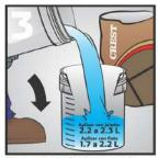
Use un recipiente limpio para mezclar. Para aplicar con jalador (fluida) vacíe de 2.2 a 2.3 litros de agua limpia y para aplicar con flota vacíe de 1.7 a 2.2 litros de agua limpia en el recipiente.
