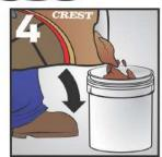
Agregue gradualmente el bulto de BoquiCREST Ultramax (10 Kg.). Mezcle continuamente hasta obtener una consistencia homogénea y libre de grumos. Deje reposar la mezcla por espacio de 2-3 minutos.
